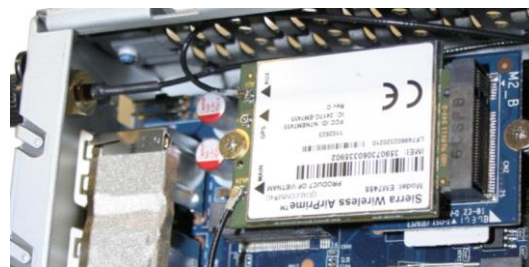
Die installierte Riser-Karte mit zusätzlicher LTE/4G-Karte (oben) und SIM-Karte (verdeckt). Die bei DL10J vorhandene WLAN-Karte mit Antenne muss zuvor entfernt werden.
