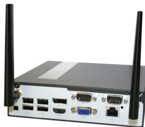
DL10J mit installierten Mobilfunk-Antennen.
